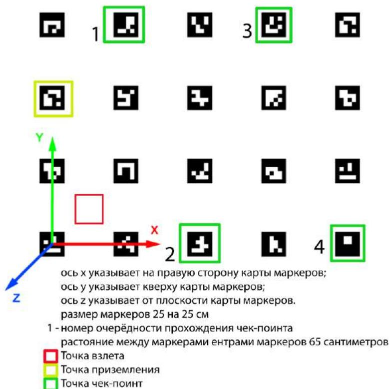
Рис. 1. Пример полётного поля с чек-пойнтами
